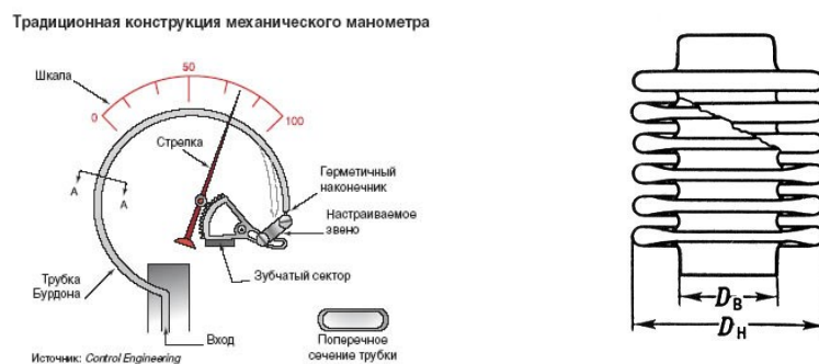
Рис. 1 Трубка Бурдона (а) и сильфон (б)
