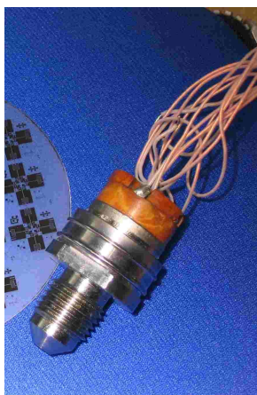
Рис. 10. Двухмембранный сенсор давления
